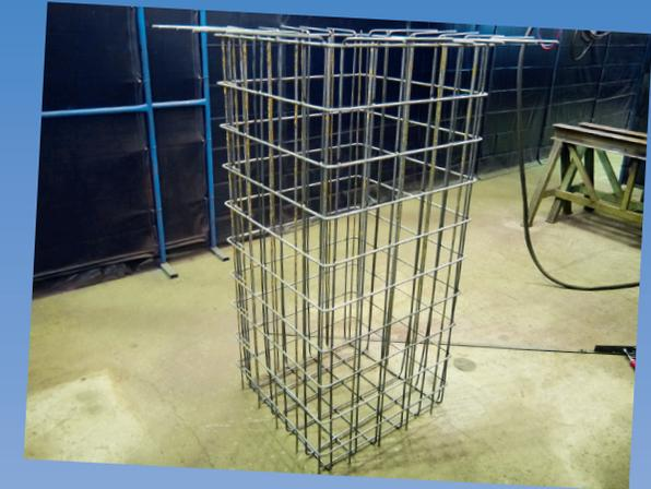
Möllers Stahlhandel GmbH verfügt über die Herstellerqualifikation nach DIN EN ISO 17660-1 und die BRL 0503 KOMO Cat.2 für die Niederlande zum Schweißen von Betonstählen B 500 mit einem Durchmesser von 8 bis 28 Millimeter. Durch diese Qualifikationen können wir nahezu alle Schweißarbeiten an unterschiedlichsten Bewehrungen übernehmen.
